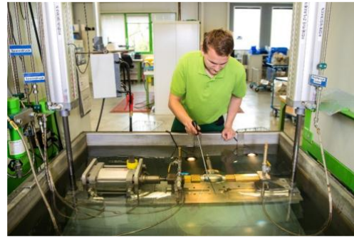
Foto 6: Dichtheitsprüfung in der Montage
