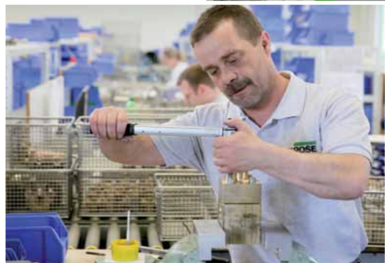
Feinmotorik gefragt: Monteur Heiko Dobberke zieht mit einem Drehmomentschlüssel die Schrauben eines Ventils an.
